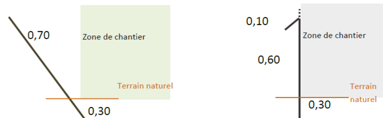
Figure 52 : Principe et caractéristiques des clôtures contre l'intrusion des amphibiens
