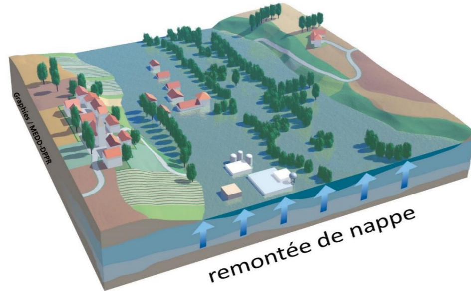
Figure 14 : Le phénomène d'inondation (Source : georisques.gouv.fr)
